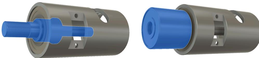
(links) Nabe 002 mit Rillenkugellager 107 und Welle 003 (rechts) + Freilauf
