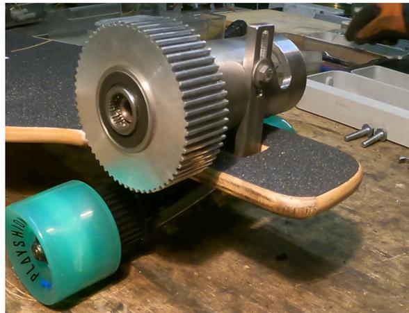
Welle-Nab-Baugruppe mit großem Synchronriemenrad 102 am Halter befestigt (ohne Bügel und Zahnriemen)
