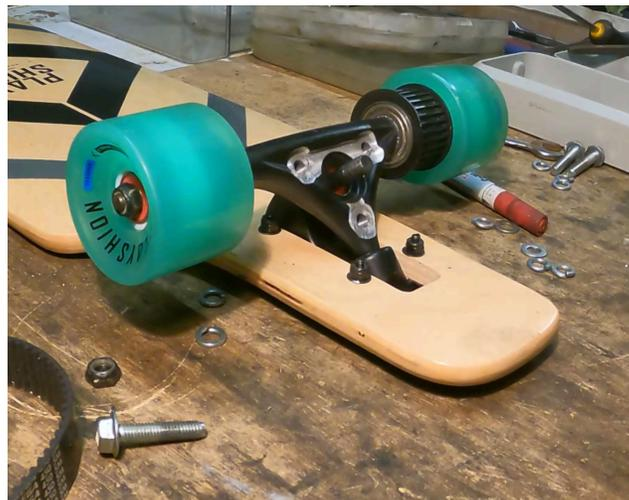
Umgebaute Achse 100 mit kleinem Synchronriemenrad 101 und Antriebsrolle
