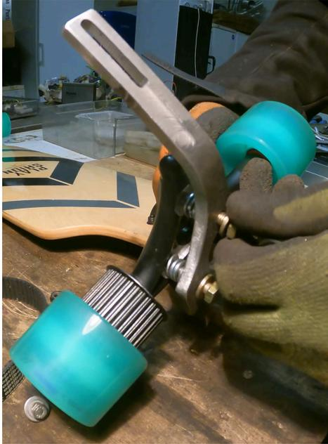
Umgebaute Achse 100 mit kleinem Synchronriemenrad 101, Antriebsrolle und Halter 001
