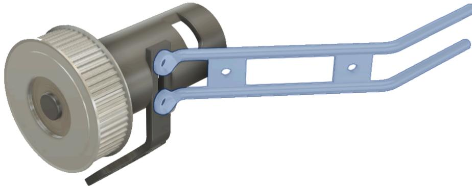
Welle-Nab-Baugruppe mit Halter und Bügel 004 verschraubt
